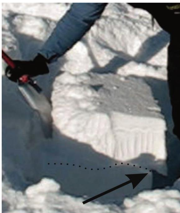
Abb. 9: Der Bruch einer Schwachschicht bei seitlicher Belastung ist durch die Verschiebung des Schneebretts leicht zu erkennen.
