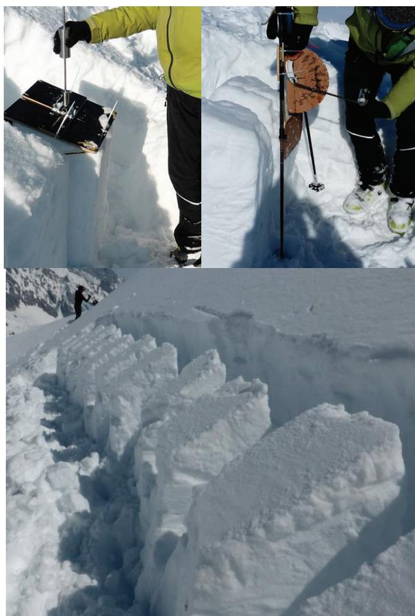
Abb. 1: Testmethode vB oben links, KBT (Pendel) oben rechts. Unten: Die Testrichtung war immer von rechts nach links, begonnen wurde mit vertikalem Belasten.
