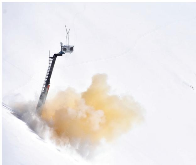
Abbildung 5: Detonation einer 5kg Ladung (Riomon T1) unterhalb eines Wyssen Lawinen-Sprengmasten im Skigebiet Silvrettaseilbahn AG.
