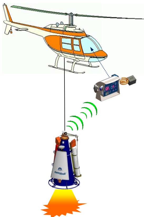
Figure 2. Vue d'ensemble du fonctionnement de DaisyBell avec l'enregistreur DaisyTrack.
