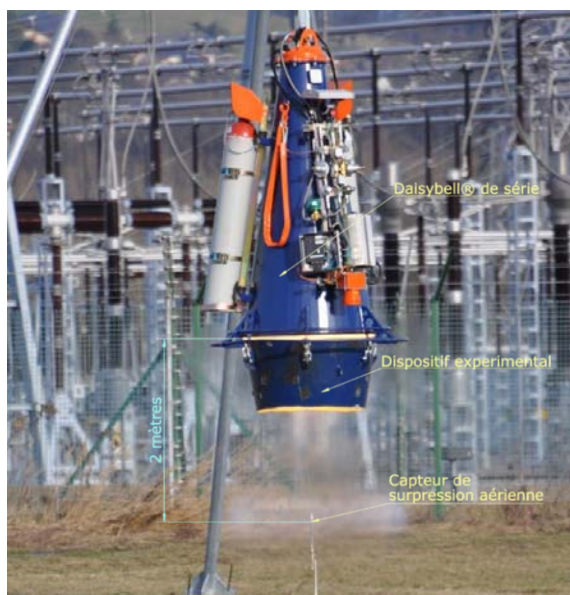
Figure 1. Mesure de surpression aérienne avec Daisybell® de série équipée du dispositif.
