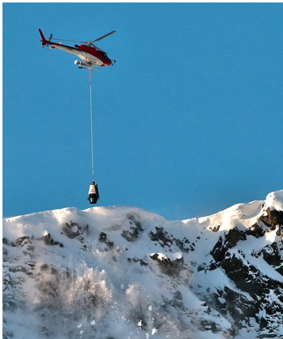
Figure 4. Opérations de déclenchements réels (MonterosaSki)
