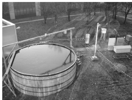
Figure 3. La piscine d'étalonnage du capteur RC pour l'élaboration de la relation entre l'atténuation du rayonnement cosmique et l'équivalent en eau situé au dessus du capteur.
